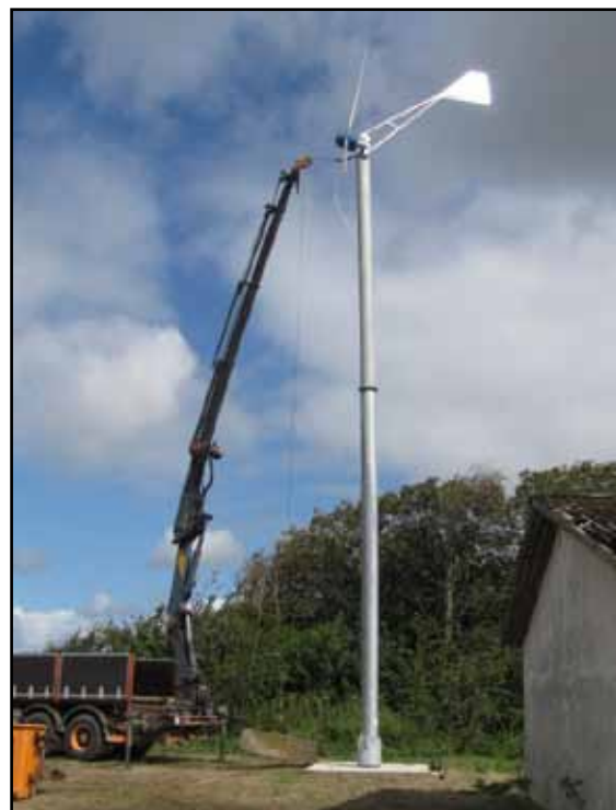
Trækprøvning af tårn med kendt vægt.
