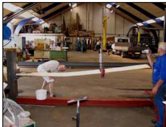
Trækprøvning af vinge i værksted.
