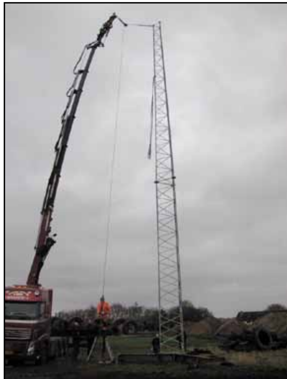
Trækprøvning af tårn med vejecelle.
