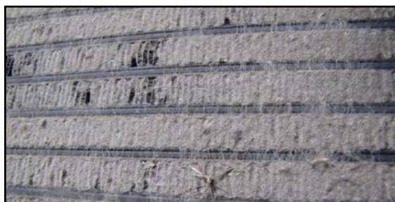
Oliekøler fundet helt tilstoppet af støv m.m. fra den omgivende luft.
