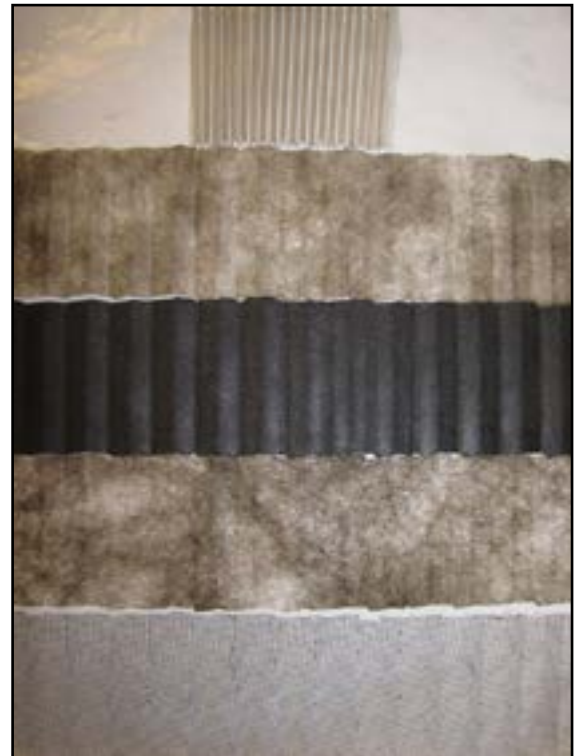
Filtret består af flere lag. I dette filter ses 5 lag. De 2 yderste er trådnæt og de 3 inderste filtdug.
