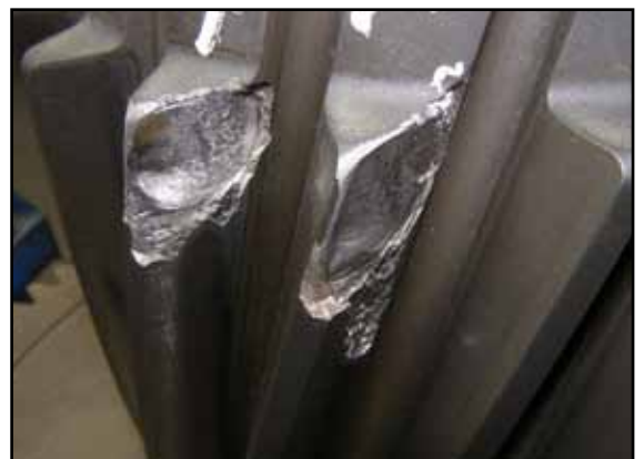
Gear fra en 1300 kW-mølle, hvor man kan se skader på flere af komponenterne i gearet.
