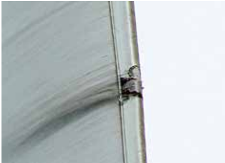
Foto 1. Vestas vinge. Tapen på forkanten er slidt væk
