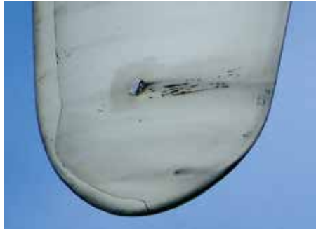
Foto 2. Vestas vinge. Skade fra lynindslag.
