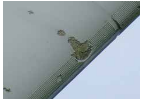
Foto 5. LM Vinge. Afskalninger på forkanten af vingen
