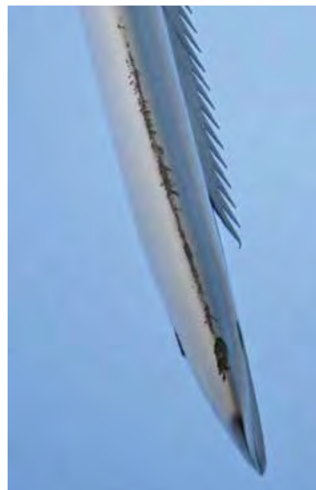
Vinge på 6 MW mølle efter få års drift.
