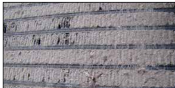
Oliekøler fundet helt tilstoppet af støv m.m. fra den omgivende luft.
