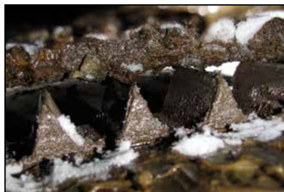
Tænder på krøjepladen på en ældre mølle er meget slidte.
